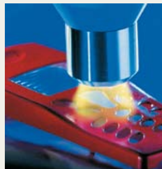
Vor dem Lackieren wird das Handygehäuse mit einer rotierenden Plasmadüse gereinigt
