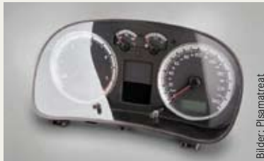
Nach dem Spritzgießen, erfolgt vor der Lackierung von Cockpitmodulgehäusen die porentiefe Reinigung mit Plasma
