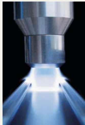
Innerhalb der Plasmadüse wird mittels Hochspannungsentladung ein atmosphärisches Plasma erzeugt
