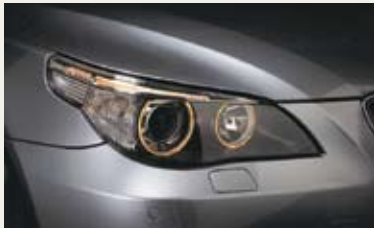
Auch bei der Lackierung von Scheinwerfer-Streuscheiben kommt die Vorbehandlung mit Plasma zum Einsatz
